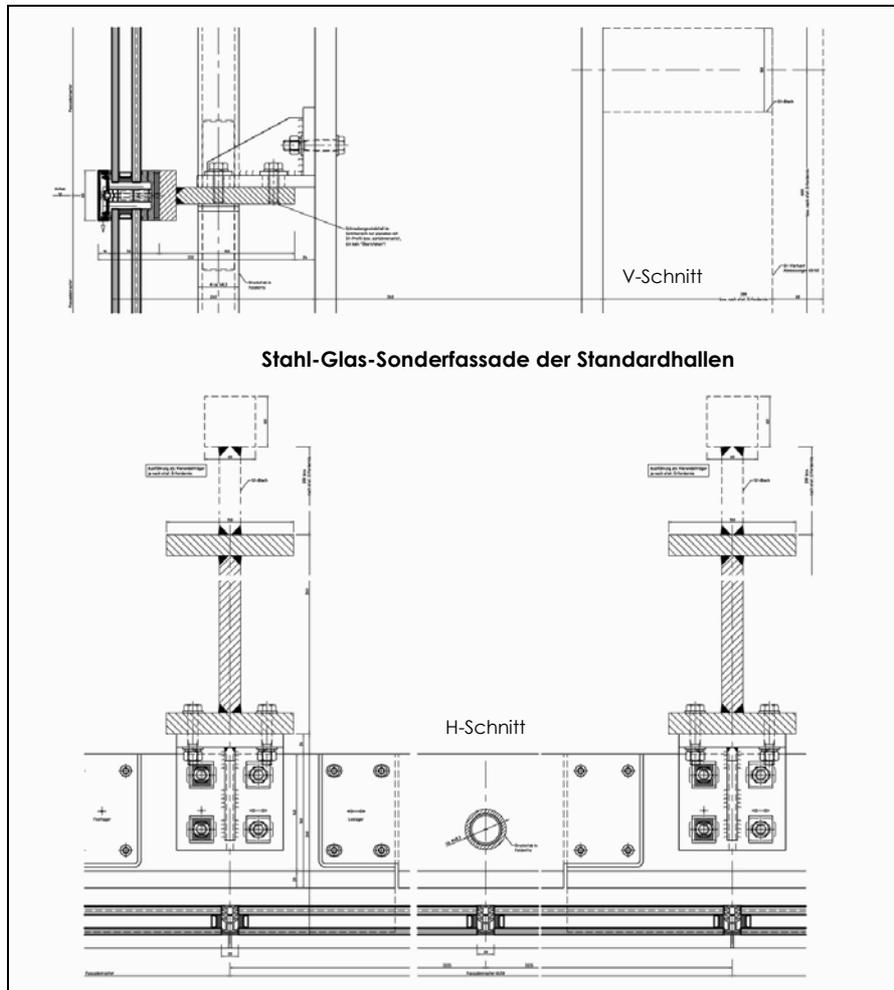
II. Statisches Berechnungsmodell einer beispielhaften Stahl-Glas-Sonderfassade:
